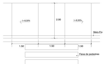
Detalhamento da rampa PNE Sem escala
