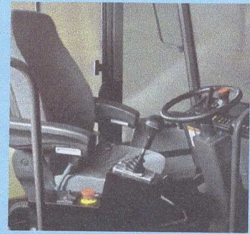
Painel integrado com assento giratório
