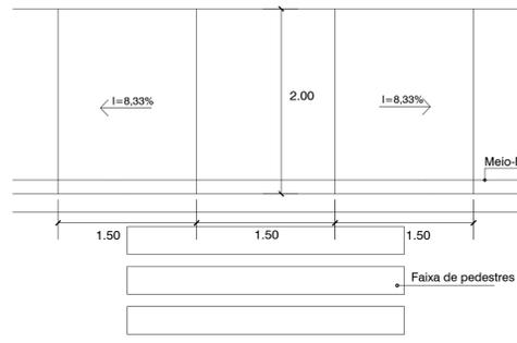
Detalhamento da rampa PNE Sem escada
