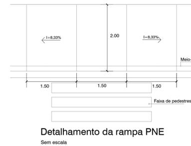
Detalhamento da rampa PNE Sem escala
